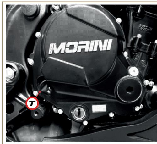
Если при заливке моторного масла используется воронка или аналогичный инструмент, проверьте его чистоту; попадание посторонних предметов в двигатель может привести к серьезным повреждениям.
